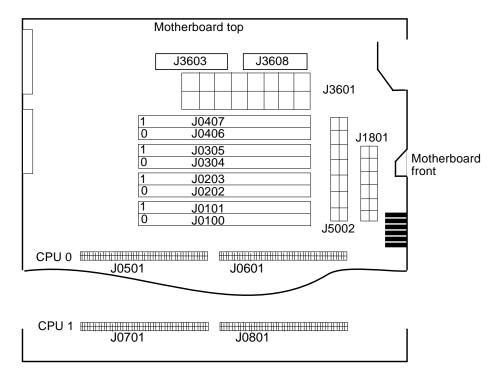
FIGURE C-4 DIMM Mapping
